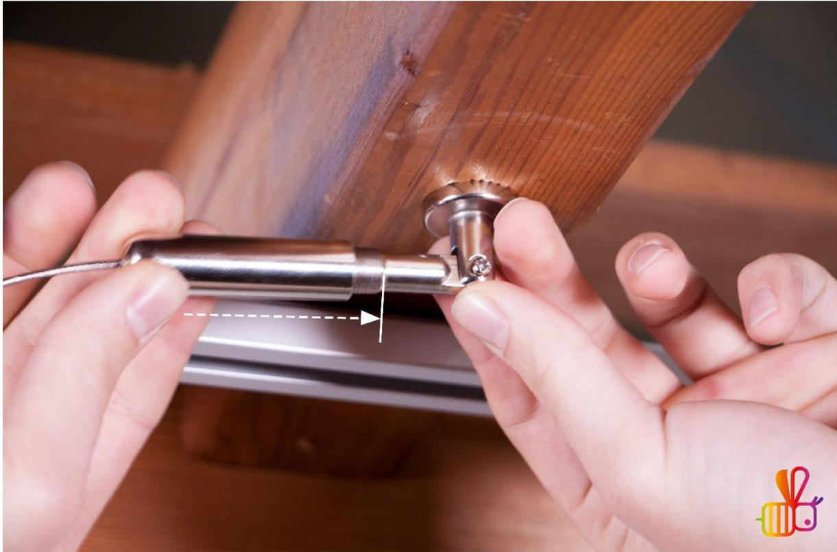
Schrauben Sie nun die Hülse soweit wieder auf die Spanntechnik, dass das Gewinde nicht mehr sichtbar ist.
