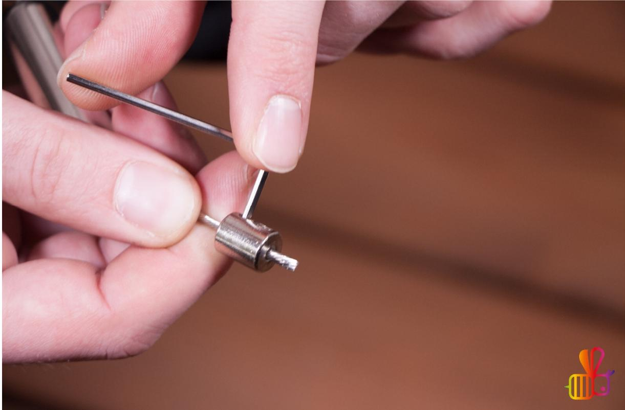
Ziehen Sie nun die Drahtseilklemme fest – ist diese zu locker, werden Sie das beim Spannen des Drahtseils merken. Das Drahtseil rutscht dann durch die Klemme, wodurch weniger Spannung erzeugt werden kann.
