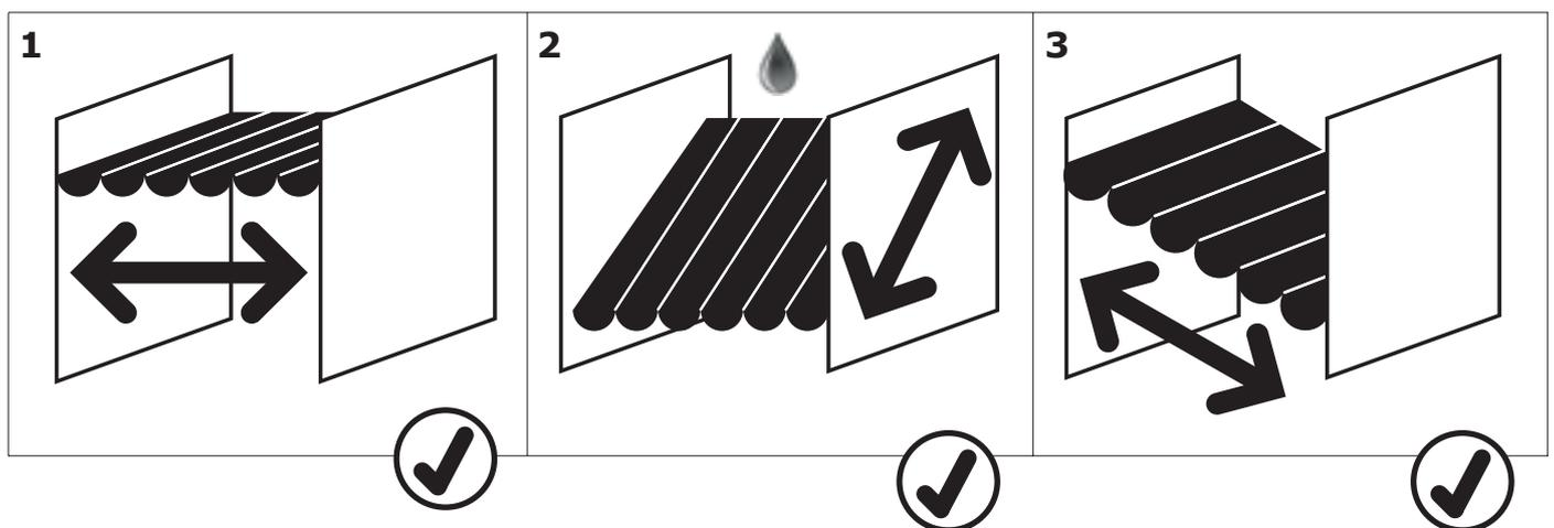
**DAS SEILSPANN SONNENSEGEL** können Sie wie oben abgebildet montieren. Achten Sie darauf, dass die Abmessungen parallel sind und auch den Maßen des Sonnensegels entsprechen! Das Seilspann Segel kann horizontal, abfallend und aufsteigend montiert werden.
